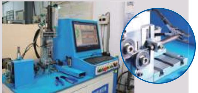
Testadas em laboratórios, as lâminas temperadas dos alicates e das tesouras da King Tony conseguem cortar facilmente espessas cordas de piano, sem grandes deformações, mesmo em uso constante. A King Tony pode afirmar, tranquilamente, que tem as lâminas mais afiadas do mercado, com maior força de penetração e menor deformidade.
